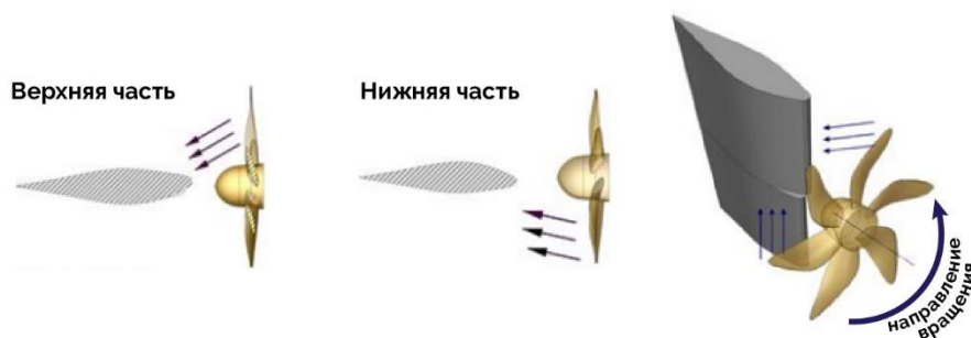
Рисунок 43 - Схематическое изображение витого руля
