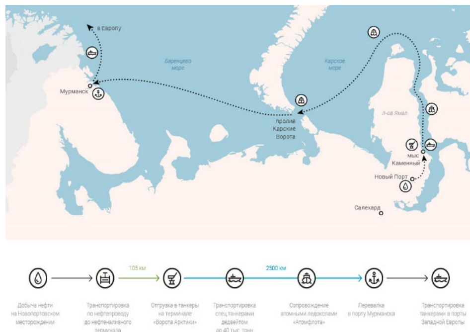
Рисунок 2 Схема транспортировки нефти с Новопортовского месторождения
